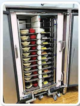
再加熱カートの内部。冷蔵のまま盛り付けし、タイマーセットする。左側が加熱され、右側は冷蔵のまま。
